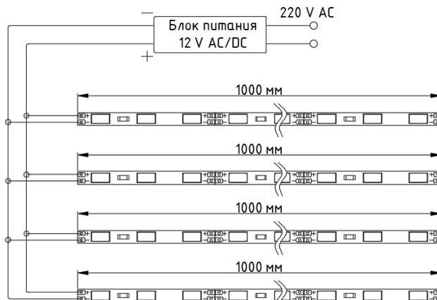
Не рекомендуется подключать последовательно больше одной линейки длиной 1 м!
