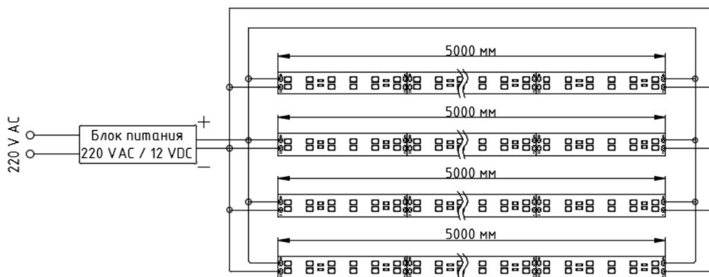
**Запрещено подключать последовательно более одной ленты длиной 5 м!**
