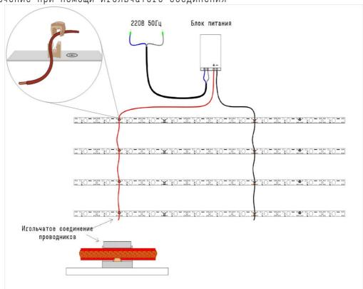
Соединение происходит с помощью штатных игольчатых клипс, расположенных на линейке. Провод, не зачищая изоляцию, вставляется в канавку с игольчатым контактом, прижимается ответной частью клипсы до щелчка. Изоляция протыкается контактной иголкой, получается электрический контакт. Для использования данного типа соединения нужно использовать провода в силиконовой изоляции.
