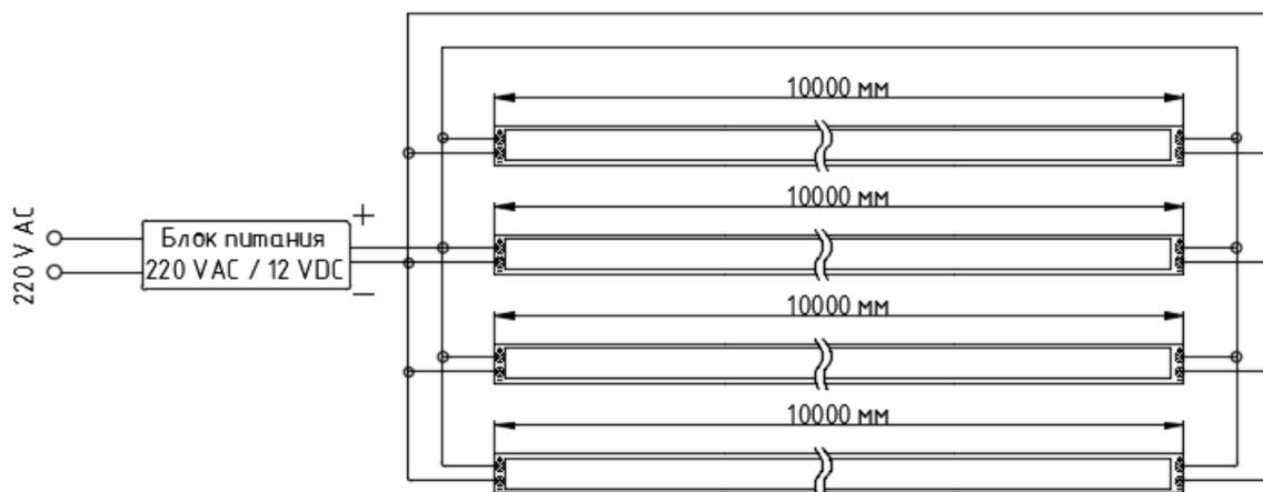
**Запрещено подключать последовательно более одной ленты длиной 10 м!**
