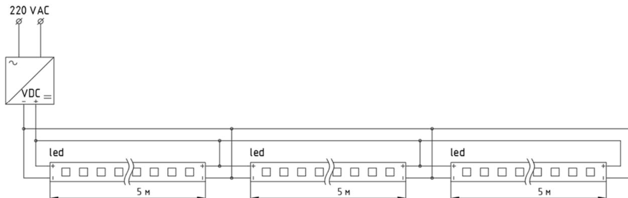
**Запрещено подключать последовательно более одной ленты длиной 5 м!**
