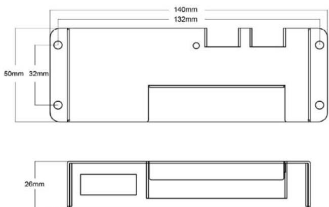
DMX-декодер предназначен для преобразования цифрового сигнала стандарта DMX512 в сигналы управления светодиодными источниками света, поддерживающими управление ШИМ.
